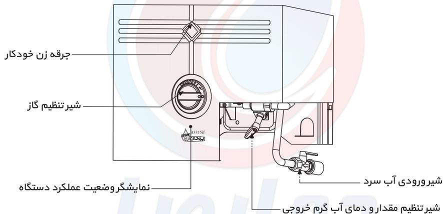
۶- مقدار و دمای آب گرم را می‌توانید با چرخاندن شیر تنظیم مقدار و دمای آب گرم خروجی تنظیم نمایید. چرخش این شیر در جهت حرکت عقربه‌های ساعت، مقدار آب خروجی را کاهش و دمای آن را افزایش می‌دهد.
