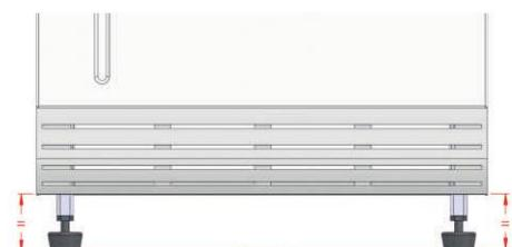
۱۲. با استفاده از پیچ های رگلاژ که در زیر پایه های پکیج تعیین
